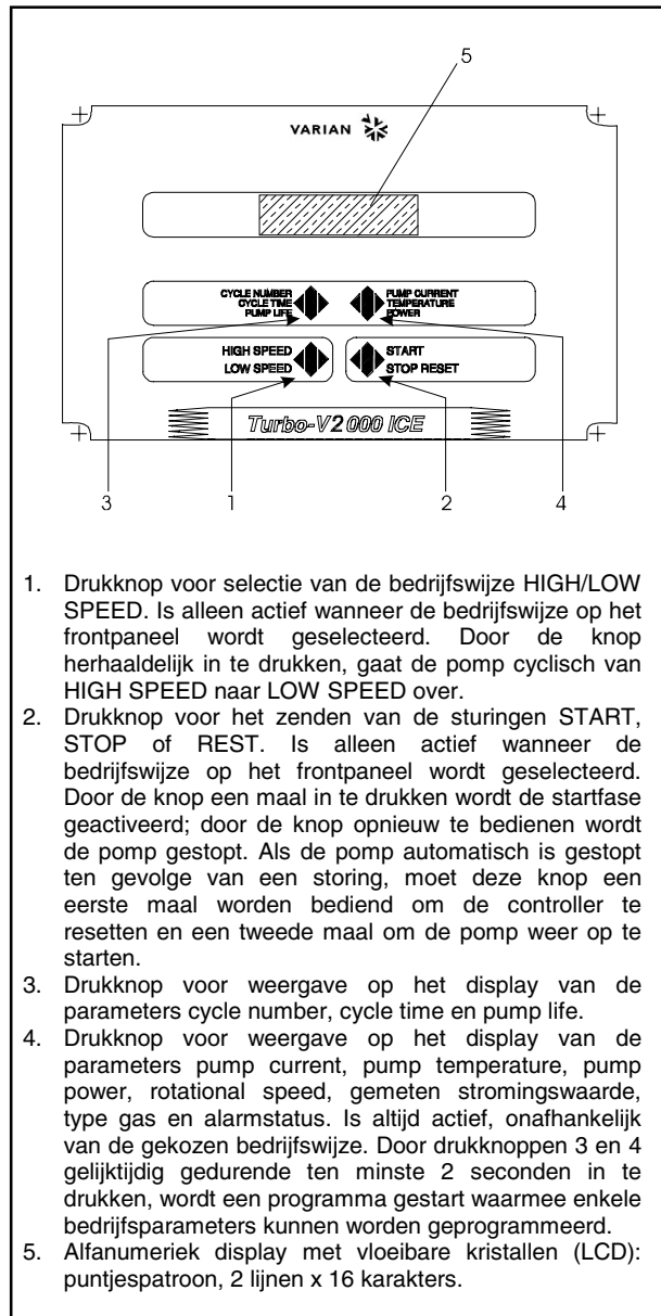
Frontpaneel van de controllers 969-9448 en 969-9449
